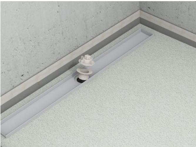
**7.** Um das Duschelement und den Ablauftopf zu verbinden, wird das Schraubstück eingesetzt und mit der beiliegenden Schraubhilfe fest gedreht. Dies verhindert ein Absacken oder Verrutschen des Ablaufes.
