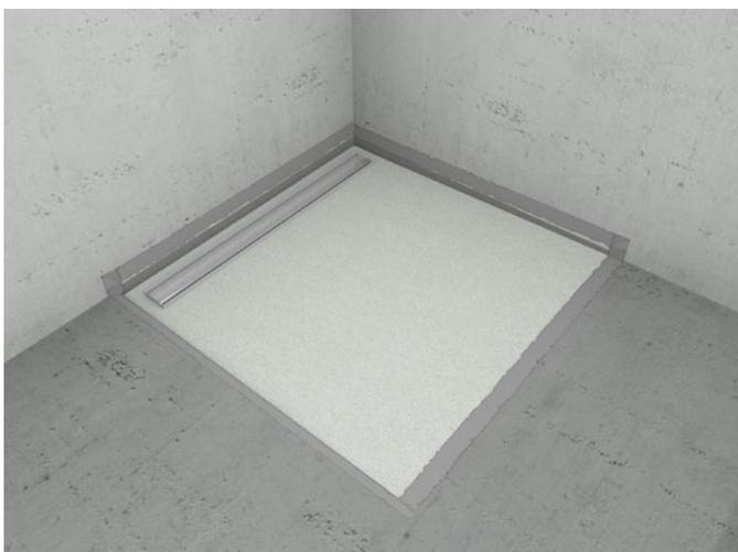
**11.** Edelstahlrost einsetzen. Das Element kann nun befliest werden. Die Versatzhöhe des Rinnenrahms beträgt 12 mm.
