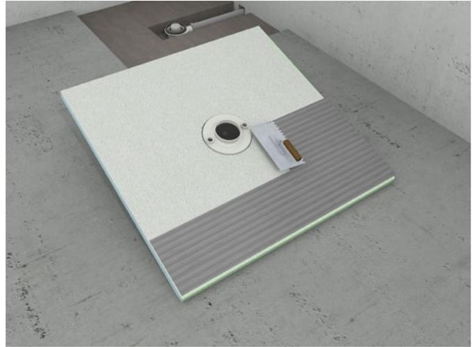
**6.** Mit einem Kammspachtel 8 mm wird Fliesenkleber (Güteklasse C2) vollflächig auf der Unterseite des Duschelementes aufgebracht.
