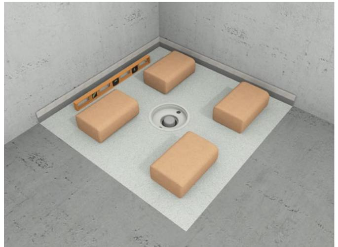
**8.** Das Duschelement ist gleichmäßig zu beschweren. Mittels Wasserwaage kann die Verarbeitung geprüft und gegebenenfalls angepasst werden.
