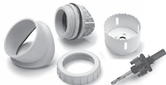
**2** Öffnung mit Lochschnneider 60 mm ins Fallrohr schneiden. Bei **GA/SML/Loro-X-Rohren** Stadur-Lochschnneider verwenden. Mit langsamer Drehzahl bohren. Kühlmittel oder Gewindeschneidöl verwenden. Nicht schräg bohren! Ränder säubern, innen und außen entgraten.
