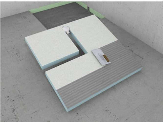
**3.** Mit einem Kammspachtel 8 mm wird Fliesenkleber (Güteklasse C2) auf der Unterseite des Duschelementes aufgebracht.
