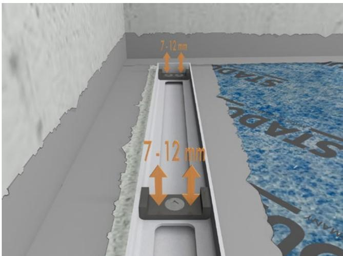
**11.** Der Rahmen mit dem Rostdesign wird auf die gewünschte Fliesenstärke eingestellt. Hierzu sind die im Lieferumfang enthaltenen Schlitten zu nutzen. Optionales Höhenverstellungs-Set bis 20 mm verfügbar.
