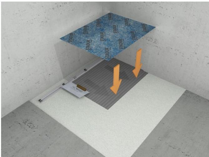
**9.** Die Dichtbahn wird mittels Fliesenkleber (Güteklasse C2) auf dem Duschelement aufgebracht. Die Dichtbahn muss dabei den kompletten aufgefüllten Bereich überlappen.
