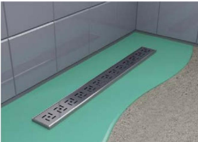
4. Flansch / Rahmen und umgebenden Fließestrich mittels alternativer Flächenabdichtung (z.B. Dichtanstrich) gemäß Herstellerangaben behandeln.
