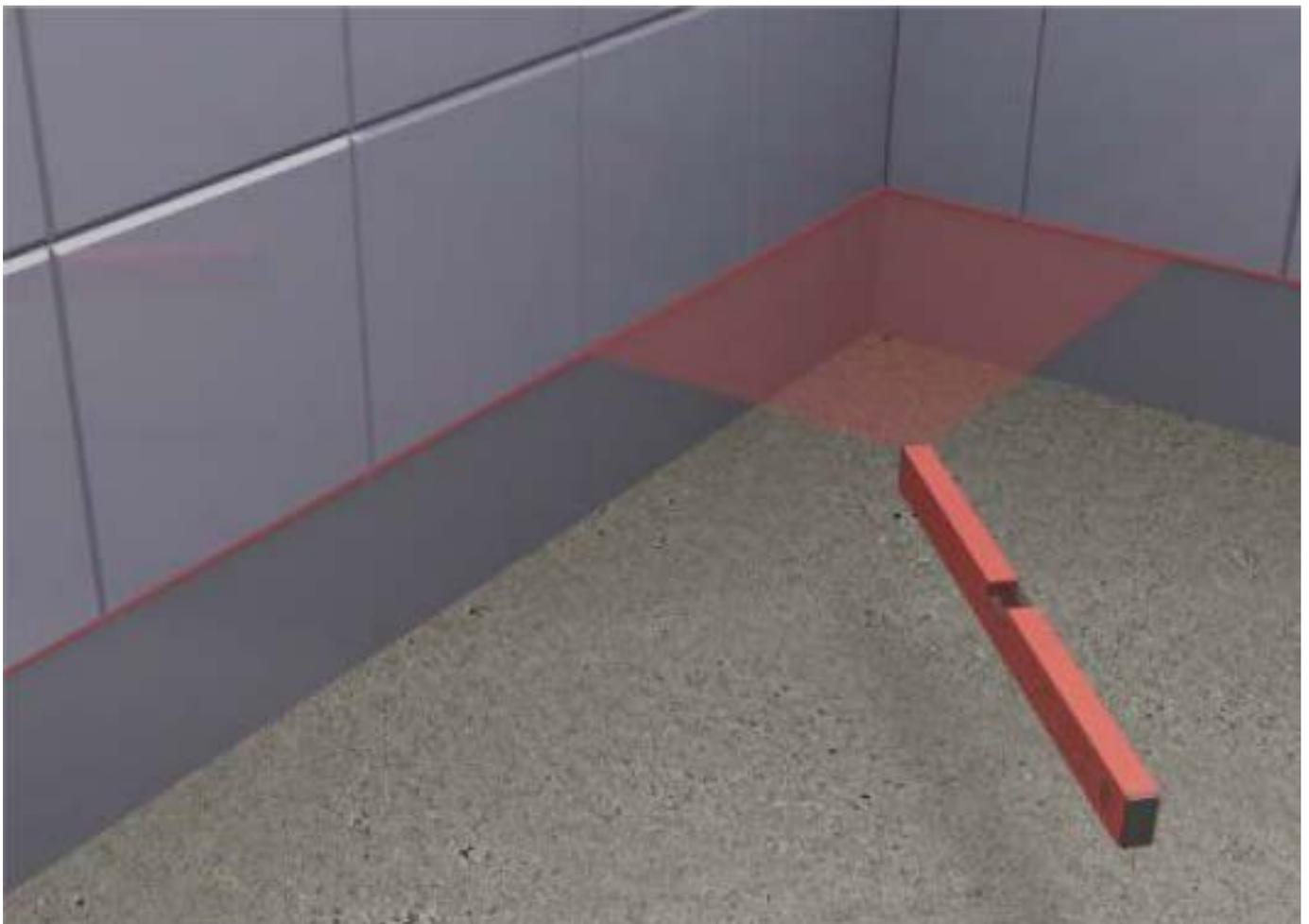
1. Nach Untergrundvorbereitung (besenrein) ist die gewünschte und notwendige Höhe, sowie das Achsmaß für die Rinneninstallation zu ermitteln. Die Höhe und Achse ist unter Verwendung der höhen- und seitenverstellbaren Rinnenfüße zu justieren (die Gefällesituation zur Rinne, sowie benötigte Höhe des Ablaufes sind zu beachten).
