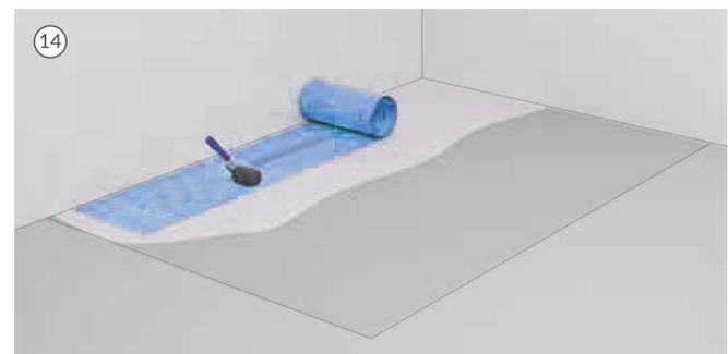
14. Bedecken Sie die Fläche um den Ablaufsockel mit Abdichtungsfolie, entfernen Sie die Trägerfolie vom Flansch und kleben Sie die Dichtungsmanschette auf. Es ist wichtig, dass die Dichtungsmanschette mit der mitgelieferten Rolle fest auf den Flansch geklebt wird.
