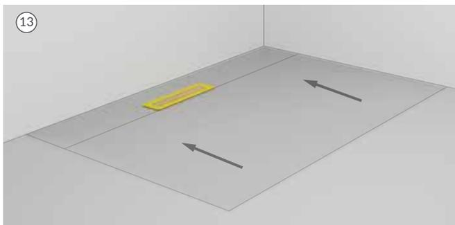
13. Füllen Sie die Einbauvertiefung mit Zementmörtel - verwenden Sie die Einbauführungen, um den Absetzschwimmer über deren Oberfläche zu führen, während Sie die geneigte Oberseite profilieren.
