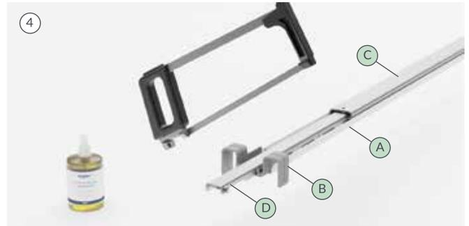
4. Die Ablaufabdeckung muss auf so zugeschnitten werden, dass diese 28 mm kürzer ist als die Rinne. Schneiden Sie diese hierfür symmetrisch an beiden Enden um die gleiche Länge zu, um die die Ablaufrinne gekürzt wurde. A - Führungstück für den Einbau B - Abschneider für die Duschrinne, den Rost und die Führungen C - Duschabflussrinne D - Gitterrost
