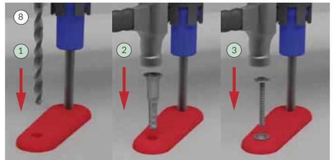
8. Schrauben Sie den Ablaufsockel mit den beiliegenden Schnellverschlussdübeln am Untergrund fest.
