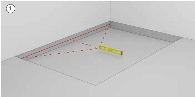
1. Bestimmen Sie das Oberflächenniveau des fertigen Duschwannenbodens an der Stelle, an der der Duschablauf angebracht werden soll (berücksichtigen Sie das richtige Bodengefälle).
