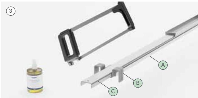
3. Schneiden Sie die Duschrinne in einem symmetrischen Abstand von beiden Enden der Rinne auf die Länge L zu. Verwenden Sie dazu den mitgelieferten Cutter, Sägeblätter aus rostfreiem Stahl und Schneidenschmiermittel das während eines vollständigen Schnitts mehrmals aufgetragen werden muss). A - Führungstück für die Installation B - Abschneider für die Duschrinne, den Rost und die Führungen C - Duschabflussrinne
