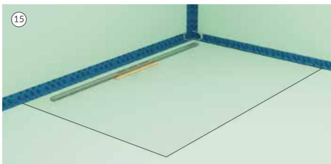
15. Verlegen Sie die gesamte Abdichtungsschicht der Duschkabine entsprechend dem gewählten System. Unmittelbar nach dem Aufbringen der Abdichtung um den Ablaufsockel wird die Ablaufrinne in ihre endgültige Position auf den Sockel gesetzt.
