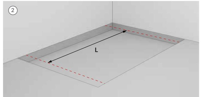
2. Messen Sie die Länge des Duschablaufs, L, d.h. die Breite der Einbaunische, reduziert um die Dicke aller Fliesen, des Fliesenklebers und der Dichtungsschicht.
