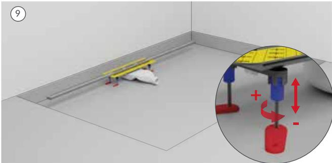
9. Platzieren Sie die Rinne über dem Ablaufsockel und stellen Sie die Oberkante der Rinne auf das richtige Niveau ein - sie sollte 3-4 mm unter der Oberkante des fertigen Duschbodens angebracht werden.
